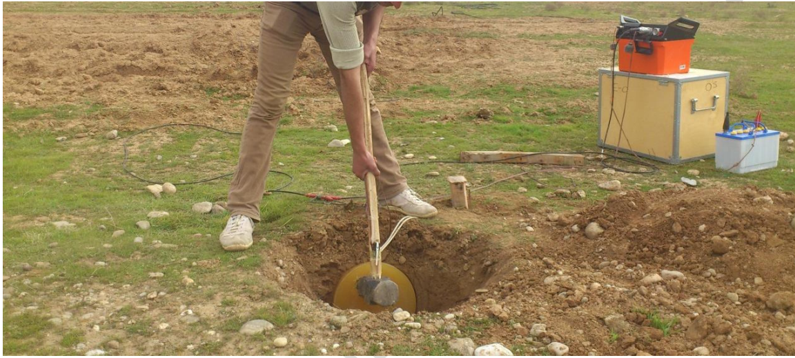
شكل (3-1):- طريقة توليد الموجات القصية S_H -Waves في الحقل باستخدام القرص البلاستيكي،
