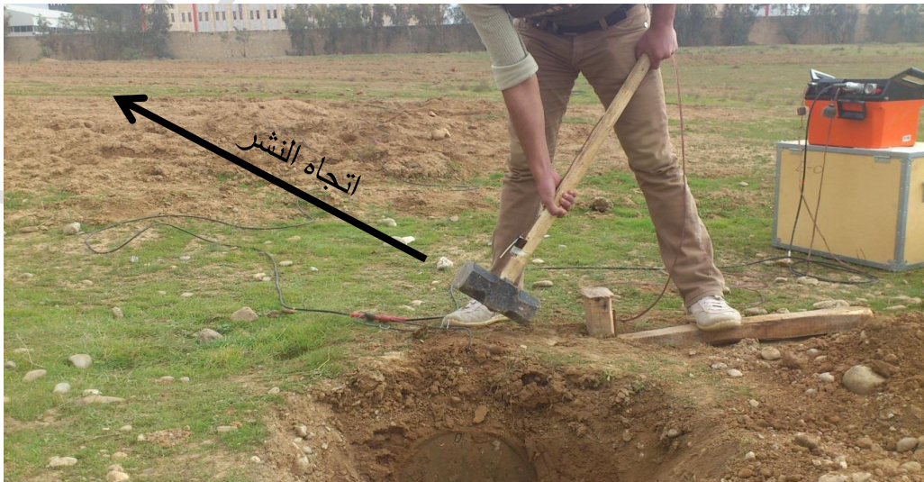
شكل (2-6) :- طريقة توليد الموجات الثانوية ذات الاستقطاب الافقي S_H ، (Al-Heetty, 2014).
